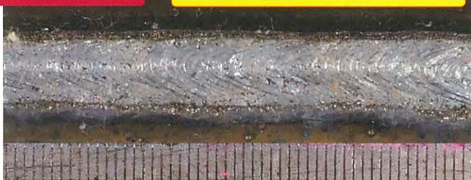
サイズ：3.2mm 溶接姿勢：水平すみ肉 溶接電流：140A
